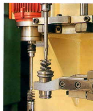
Szczotka do powierzchni wewnętrznych usuwa grat z otworów poprzecznych w korpusie zaworu.
