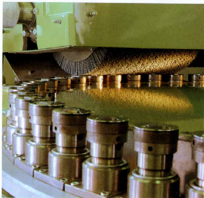
Szczotka walcowa z wypełnieniem typu ANS usuwa grat z wielostronnych noży skrawających w maszynie gratującej ze stołem obrotowym.
