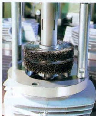
Tutaj jednotarczowa szczotka typu Alpha usuwa grat z głowicy cylindra.
