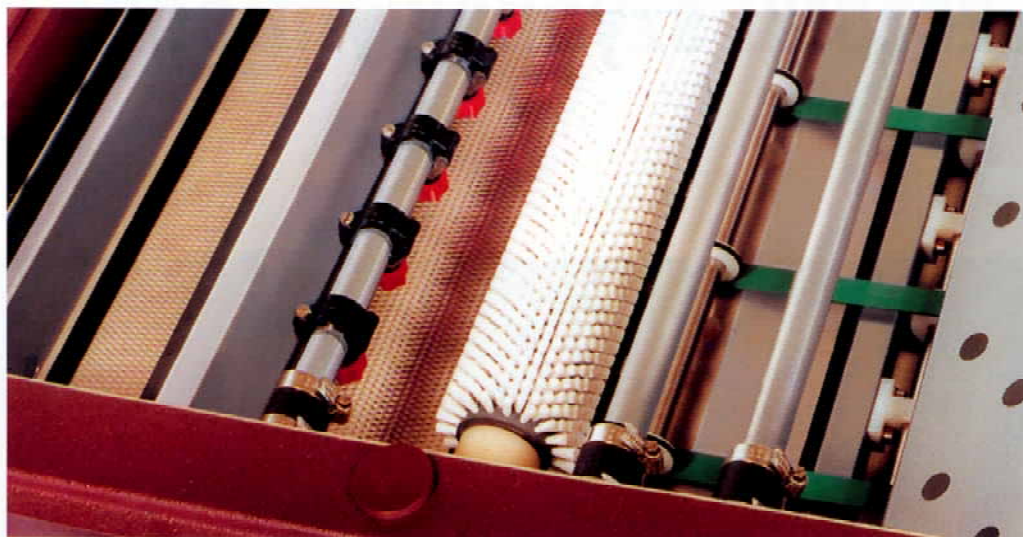
Szczotki walcowe są nieodzowne w maszynach do wywoływania płyt offsetowych
