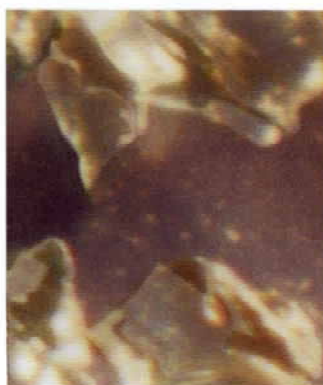
Węgiel krzemu - SIC - najwyższa mikrotwardość na poziomie 25000 N/mm 2 , szczególnie ostre krawędzie.
