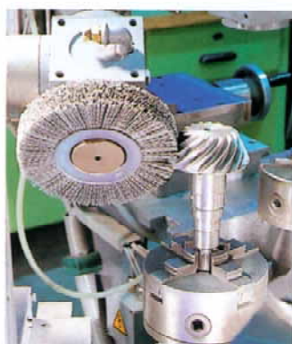
Jednotarczowa szczotka typu Alpha obrabia stożkowe koło zębate ze stali.
